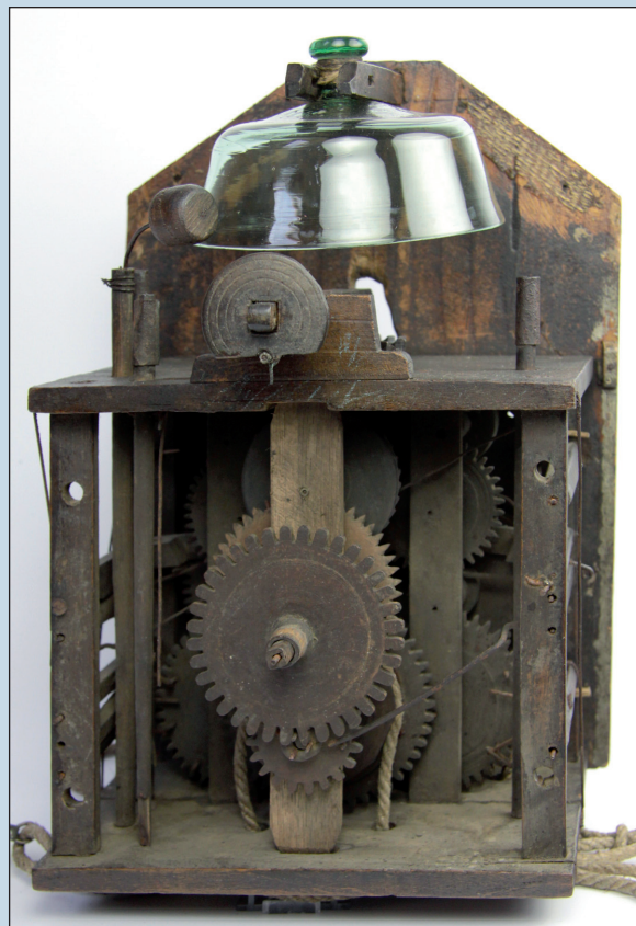
Celodřevěné hodiny s předním kyvadlem, bití do skleněného zvonku. Wooden clock with frontal pendulum, striking the time on a glass bell.
